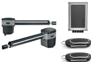
ALUTECH SCOPIO SC-3000SKIT-N Комплект электроприводов для распашных ворот. Открытие створок внутрь и наружу. Двигатель 230В, мощность 150 Вт, тяговое усилие 3000Н,  $m_{max} = 350$  кг, скорость 0,16 м/с, интенсивность 25%, IP54. Со встроенными концевыми выключателями и LED-подсветкой.
